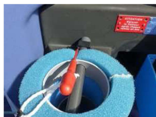
Insérer pour cela la tête plate d'un petit tournevis dans le(s) collier(s).
